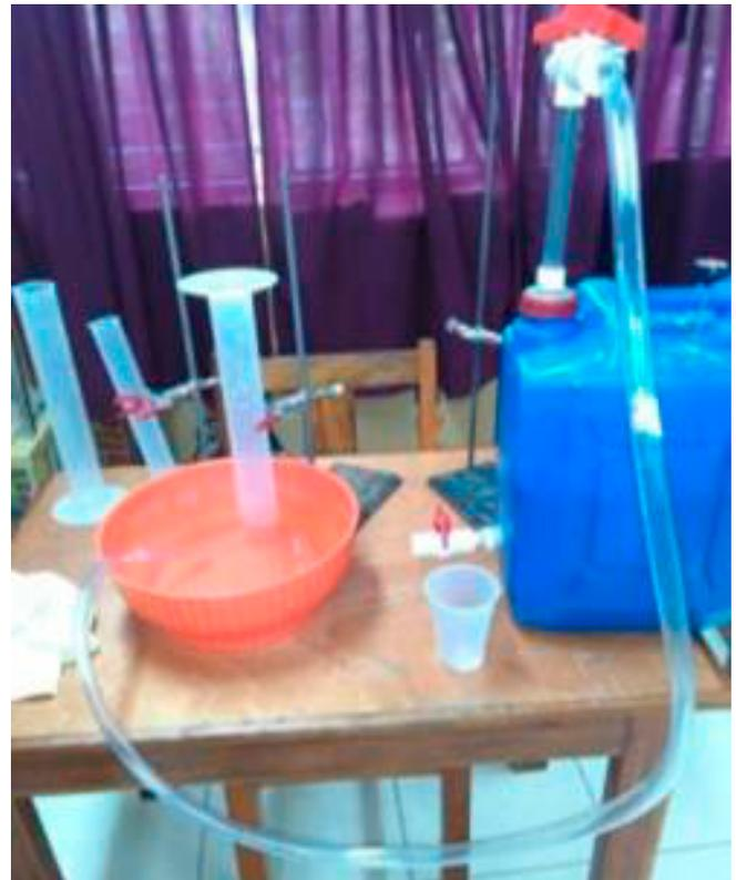
Fig 8 Medicion de producción de biogas
