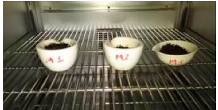
Fig. 2 Sustrato en horno a 550 oC
