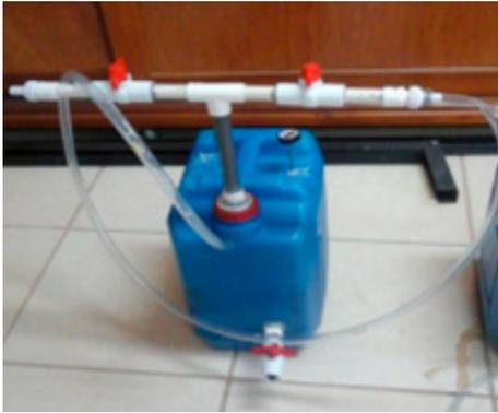
Fig. 6 Llenado de biodigestores
