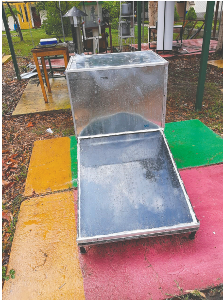
Figura 2. Deshidratador solar construido
