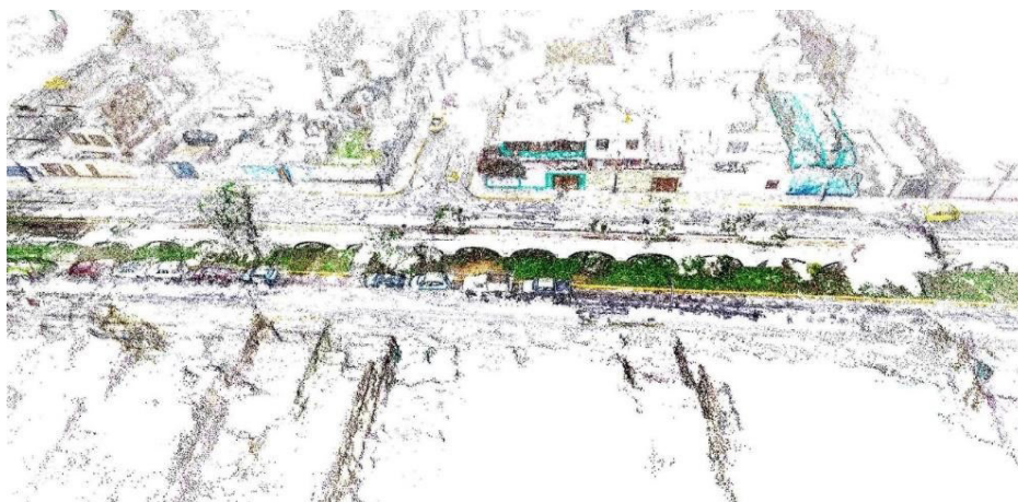
Figura 9: Nube de puntos del Acueducto de la Hacienda San Juan de Villa.
