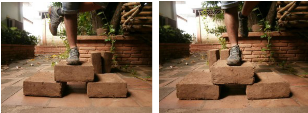
Fig. 12. Foto de prueba de calidad por peso en prototipo no. 1 y no 2, de izquierda a derecha.
