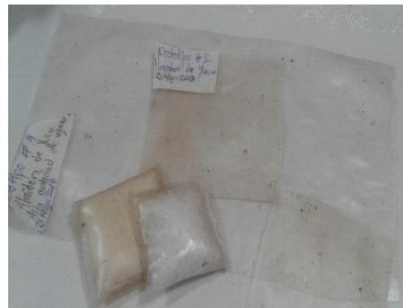
Figura 8: Elaboración de sachetz como alternativas al empaçado alimentario elaborados a partir de almidones termoplásticos.
