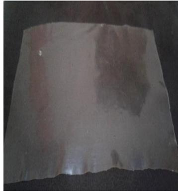
Figura 5: Biopelícula de almidón termoplástico.
