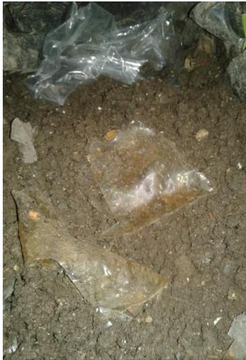
Figura 13: Comparación de biodegradación de almidón termoplástico sometido a medio de compostaje junto con plástico convencional.
