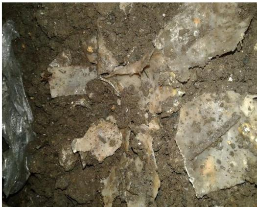
Figura 20 Prototipos atacados por microorganismos y descompuestos por la acción enzimática de estos y por el alto contenido de humedad.
