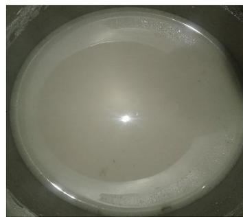
Figura 3: Almidón disuelto en 100 ml de solución de ácido acético glacial al 3 % y agua destilada.
