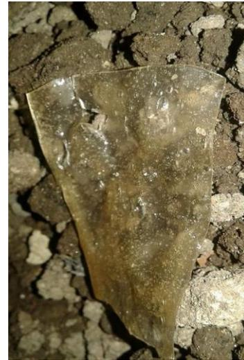
Figura 15: muestra de prototipo de almidón termoplástico de yuca sometido a medio de compostaje.
